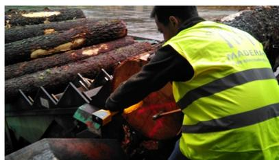
Realizados los ensayos de propiedades sónicas para determinar la calidad de la madera
